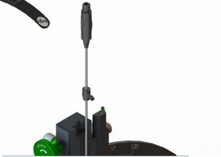
Fig. 3: Quando o centro da janela está posicionado na mira, o Stop deve ser preso à cânula.
